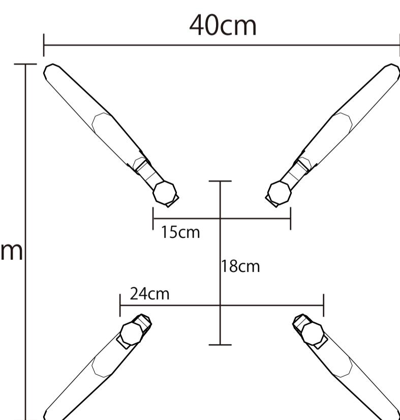
右図の寸法に合わせて、①②の筒を接着する。
